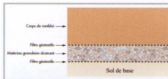
Figure 1 Solution traditionnelle en couche granulaire et filtres géotextiles Traditional solution with granular layer and geotextile filters
