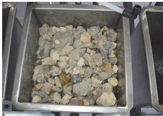
Figure 3. Matériau granulaire lavé utilisé en référence (dimensions de la cellule : 250 mm x 250 mm)
