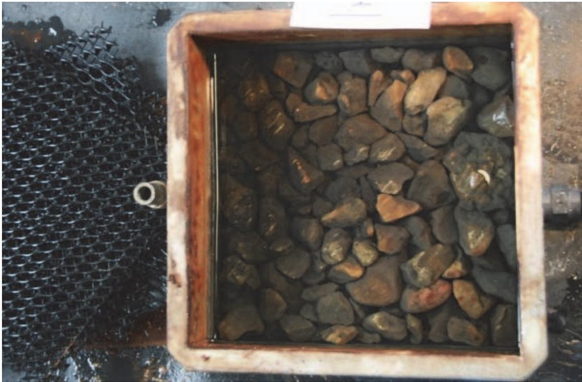
Figure 9. Apparence du matériau granulaire immédiatement après l'ouverture d'une des cellules
