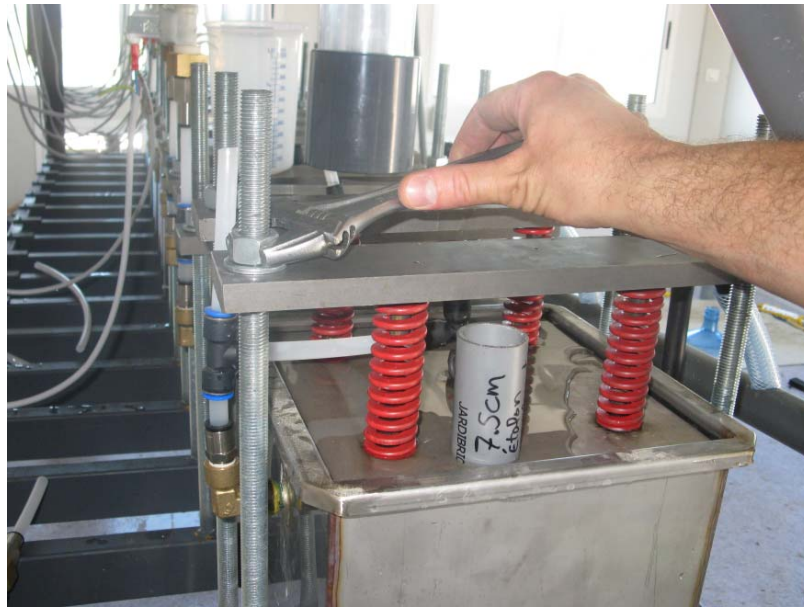
Figure 4. Dispositif de contrôle de la contrainte normale
