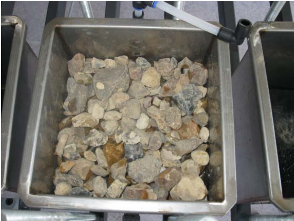
Figure 7. Gravier drainant utilisé en référence (dimensions de la cellule : 250 mm x 250 mm)
