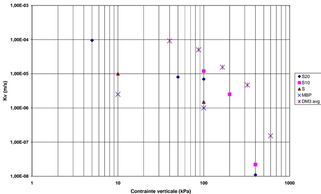
Figure 2 : Variation des perméabilités de déchets avec la contrainte de confinement
