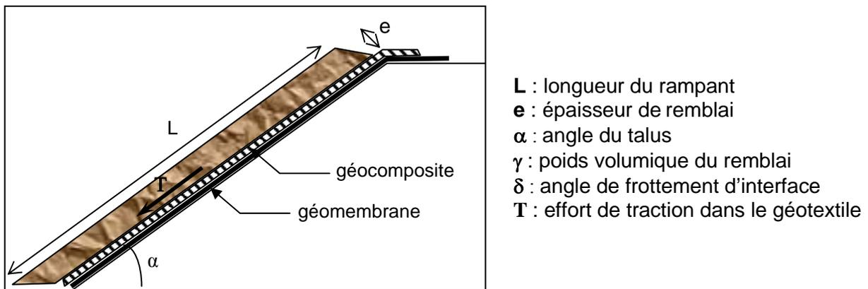
Figure 3 : Définition des paramètres servant au dimensionnement du géocomposite
