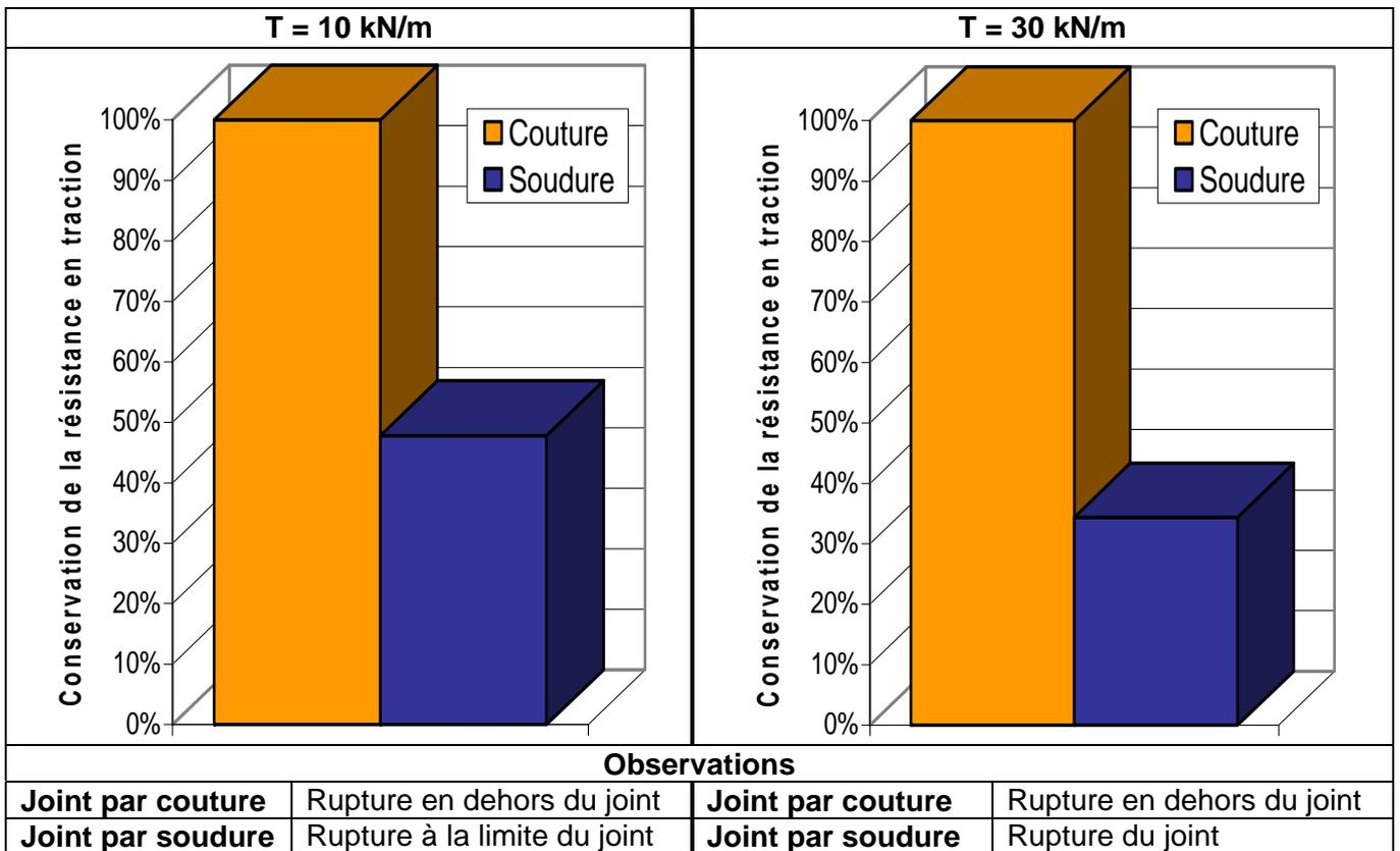
Figure 7: Récapitulatifs des essais réalisés sur les joints entre lés
