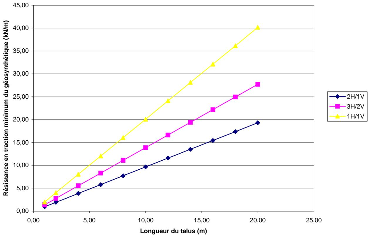
Figure 4 : Résistance en traction nécessaire pour une surcharge de 0,30 m de neige
