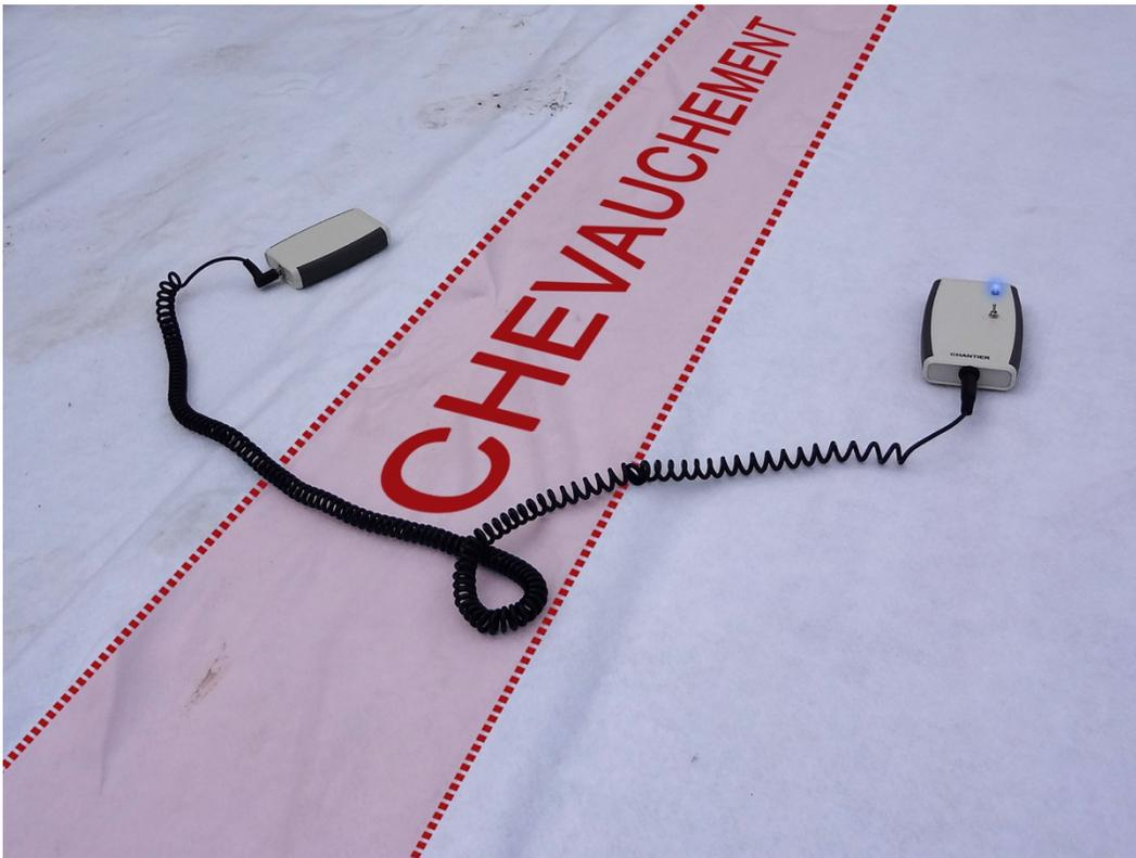
Figure 5 : Testeur de continuité pour fins de contrôle-qualité
