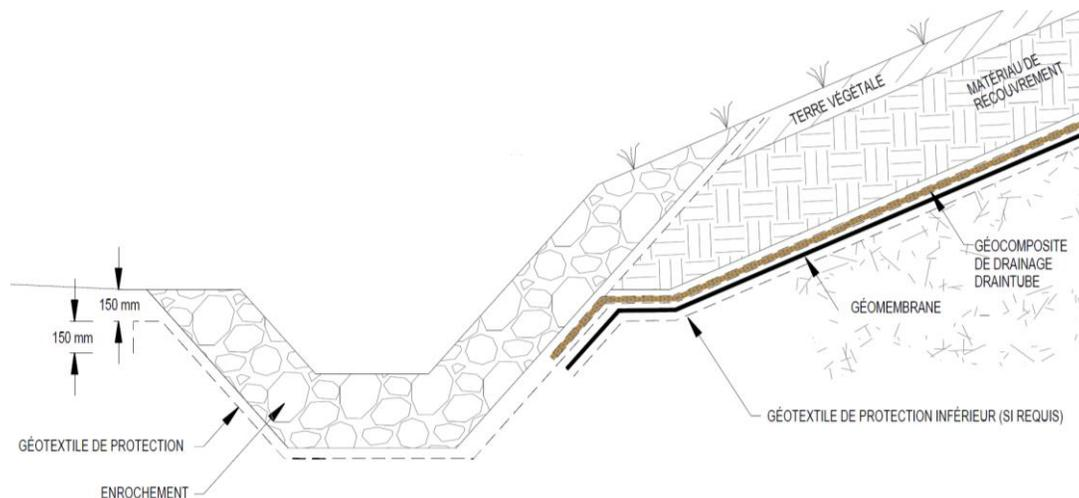
Figure 10: Raccordement à un fossé
