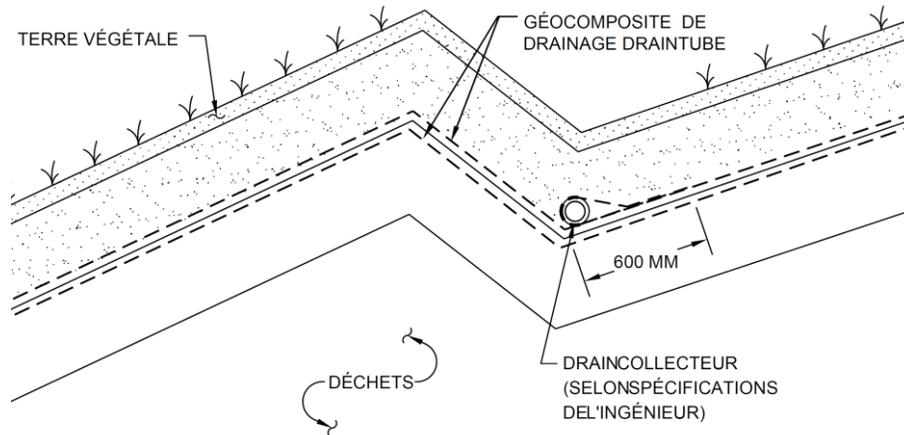
Figures 11: Coupe type de raccordement à un drain d'interception
